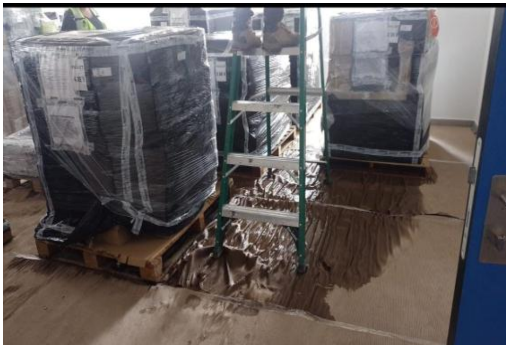
Humedad entre el carton corrugado y pallets
